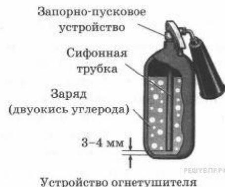
Для приведения в действие углекислотного огнетушителя необходимо направить раструб-снегообразователь на очаг пожара и нажать на рычаг запорно-пускового устройства.
